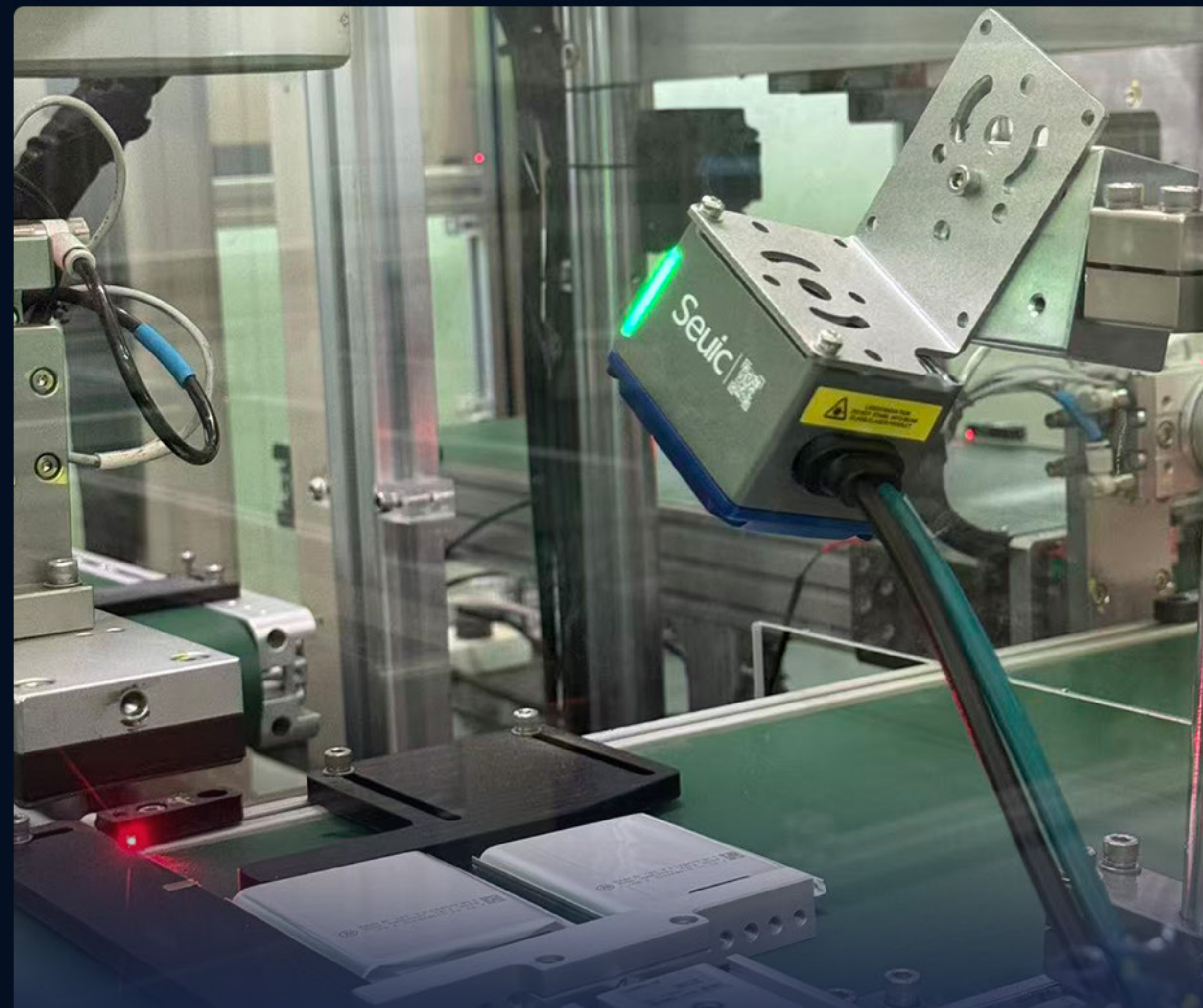
锂电池行业 铝塑膜喷码读取
